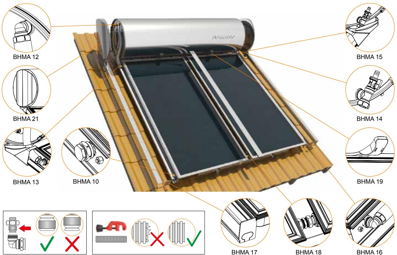
10. Τοποθετούμε και σφίγγουμε την τάπα μηχανικής σύσφιξης Ø22 στο επάνω δεξί και κάτω αριστερό άκρο του/ των συλλεκτών. Τοποθετούμε το μπόιλερ πάνω στη βάση με τα ηλεκτρικά μέρη αριστερά, βλέποντας τον ηλιακό θερμοσίφωνα από μπροστά.
