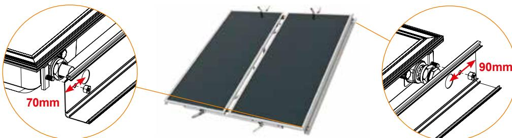
10. Τοποθετούμε και σφίγγουμε τις τάπες μηχανικής σύσφιξης Ø22 στο επάνω δεξί και κάτω αριστερό άκρο του/των συλλέκτη/κτών.\* Τοποθετούμε το μπόιλερ πάνω στη βάση με τα ηλεκτρικά μέρη αριστερά, βλέποντας τον ηλιακό θερμοσίφωνα από μπροστά.
